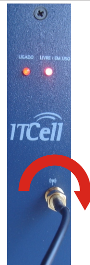
FIGURA 3 - CONEXÃO DA ANTENA GSM
